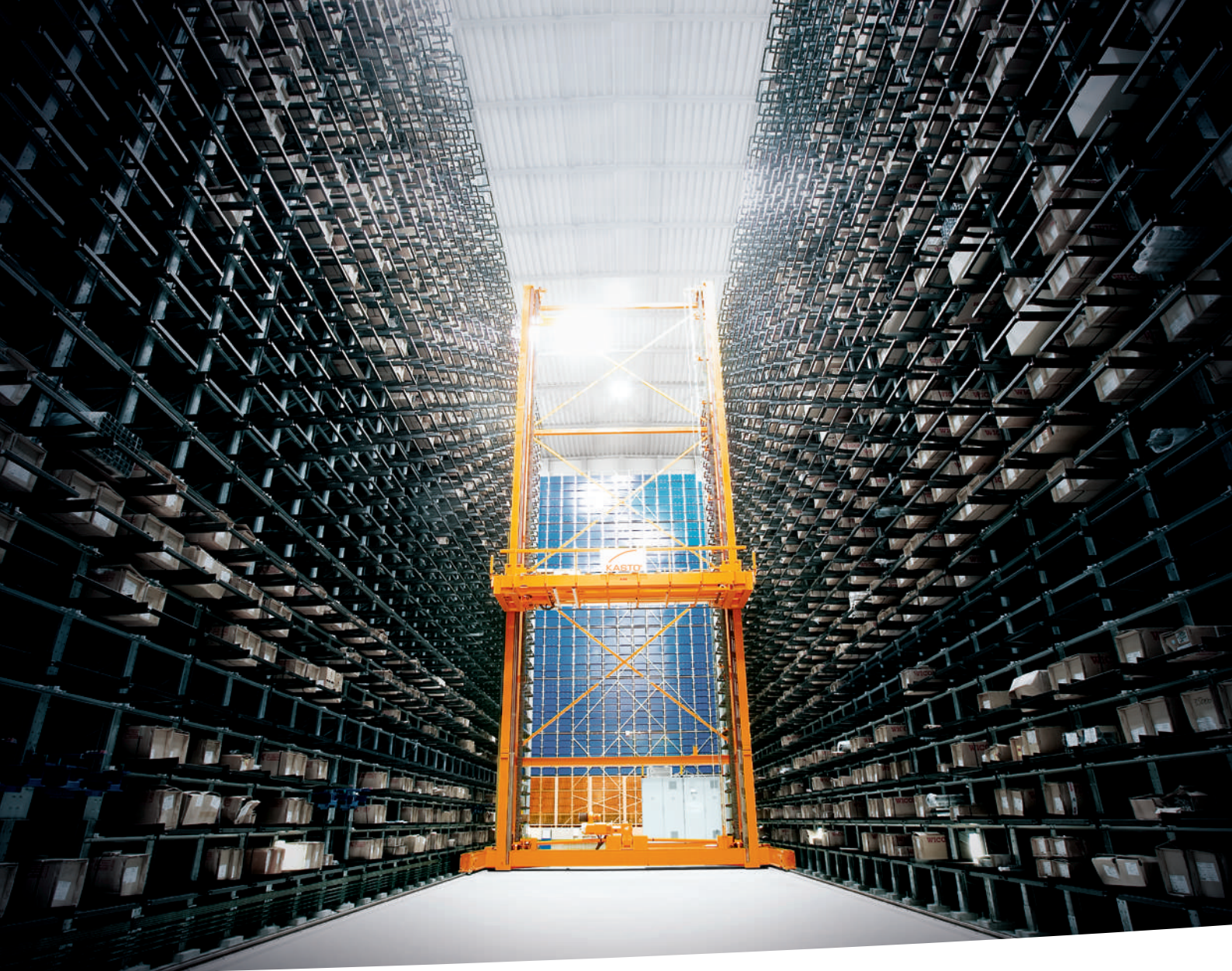
UNICOMPACT : 大規模・高速アクセス型 棒材用立体自動保管システム 出庫ステーションのバリエーションが豊富。
