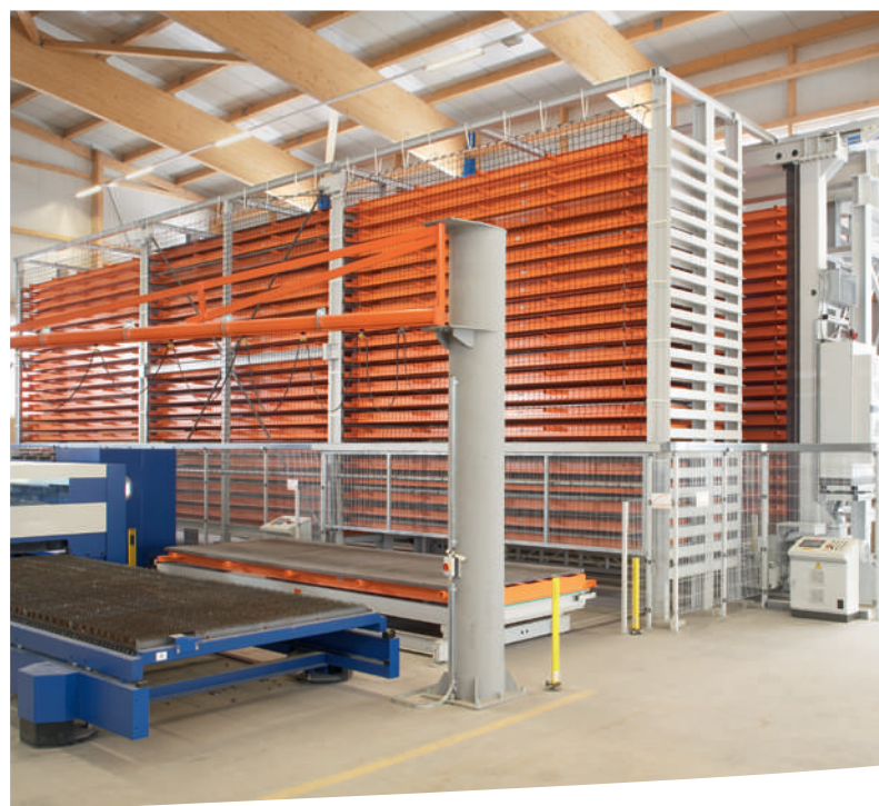
UNILINE : (写真 上・下) 大規模・高速アクセス型 鋼板用立体自動保管システム 出庫ステーションのバリエーションが豊富。
